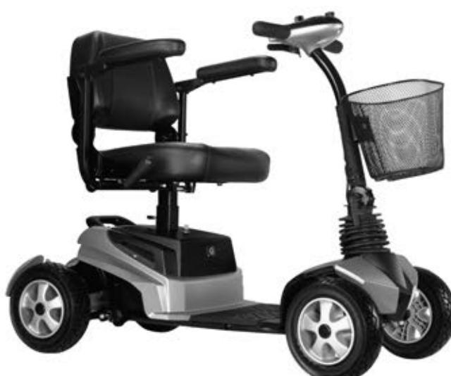
**SWIFT** je čtyřkolový, lehký, kompaktní skútr nižší třídy, s jednoduchým ovládáním. Je snadno rozložitelný, což usnadňuje jeho případný transport. Celková hmotnost bez baterií je přibližně 48 kg. SWIFT je vybaven odpruženým zavěšením zadních kol s 9,5" (24,0x7,5 cm) zadními a předními koly. Jeho maximální nosnost je 120kg a maximální rychlosť jízdy až 8 km/h. Skútr SWIFT je určen pro uživatele s menším vztřístem a oceníte při vycházkách po městě nebo nákupech.
